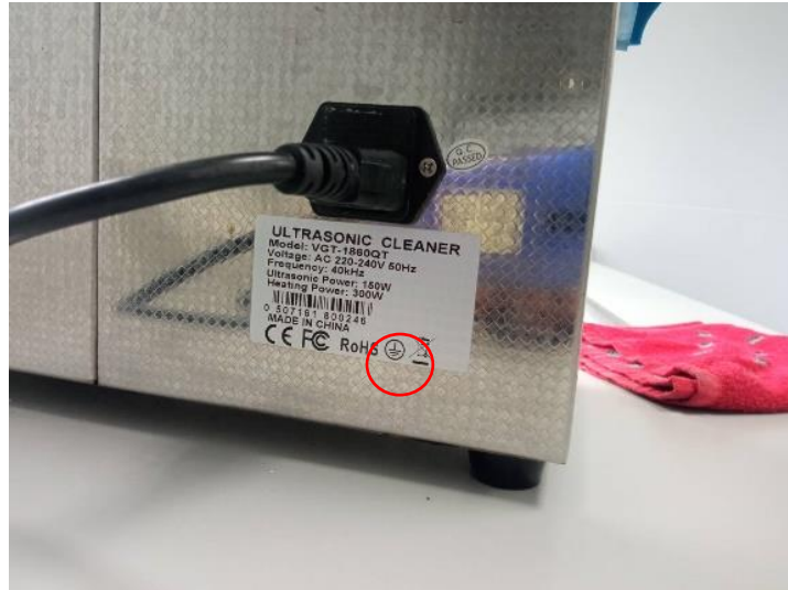
รูปที่ 14.2 อุปกรณ์ไฟฟ้าในห้องปฏิบัติการที่มีสัญลักษณ์สายดิน
